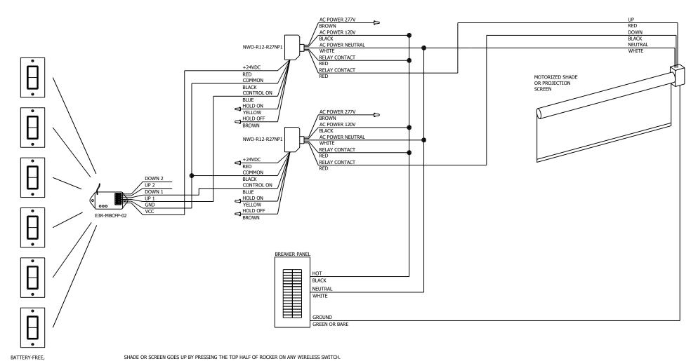
SHADE OR SCREEN GOES UP BY PRESSING THE TOP HALF OF ROCKER ON ANY WIRELESS SWITCH. SHADE OR SCREEN GOES DOWN BY PRESSING THE BOTTOM HALF OF ROCKER ON ANY WIRELESS SWITCH.
